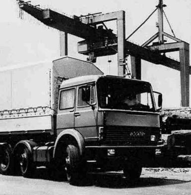
OM è specialista per combinazioni 3+2 e 44 t di PTC. Completa la gamma 190 e ne ripropone le qualità: la durata, la capacità di carico, il collaudatissimo diesel 8V (352 CV), il confort. Consente diverse possibilità di ripartizione di carico tra motrice e semirimorchio: da 20 a 24 t sulla motrice, da 24 a 20 sul semirimorchio La sicurezza dei due assi
